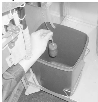
Рисунок 20 — контейнер для сбора жидких отходов.
