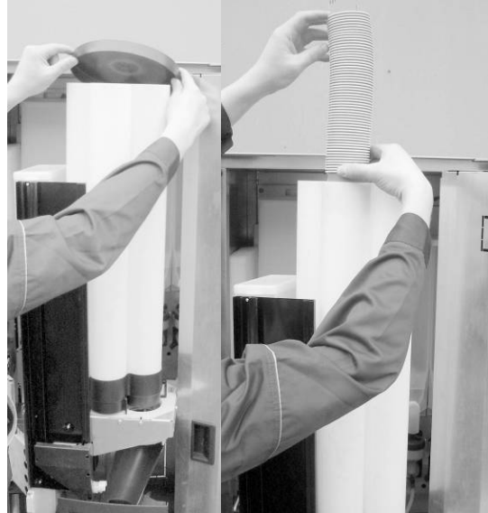
Рисунок 17 — обслуживание диспенсера стаканов
