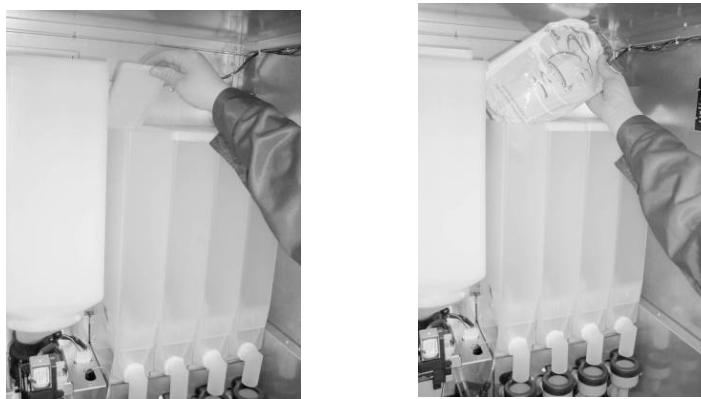
Рисунок 16 — обслуживание контейнеров для растворимых ингредиентов.
