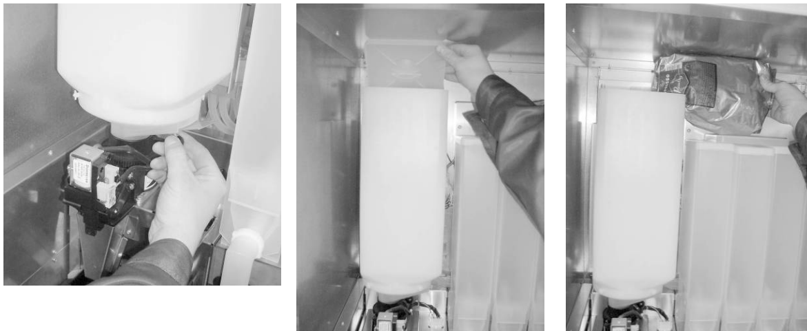
Рисунок 15 — обслуживание контейнера для кофе.
